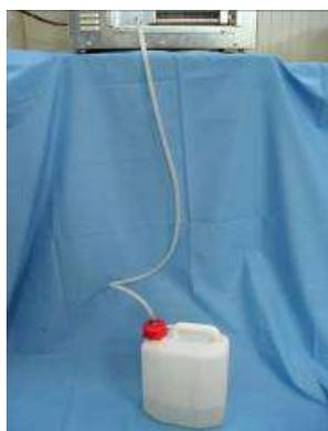
Posizionare il recipiente di condensa al di sotto della linea del raccordo di scarico. Il recipiente di condensa va posto al di sotto della linea del raccordo ed il tubo di condensa NON DEVE né arrotolarsi né creare blocchi allo scarico.
